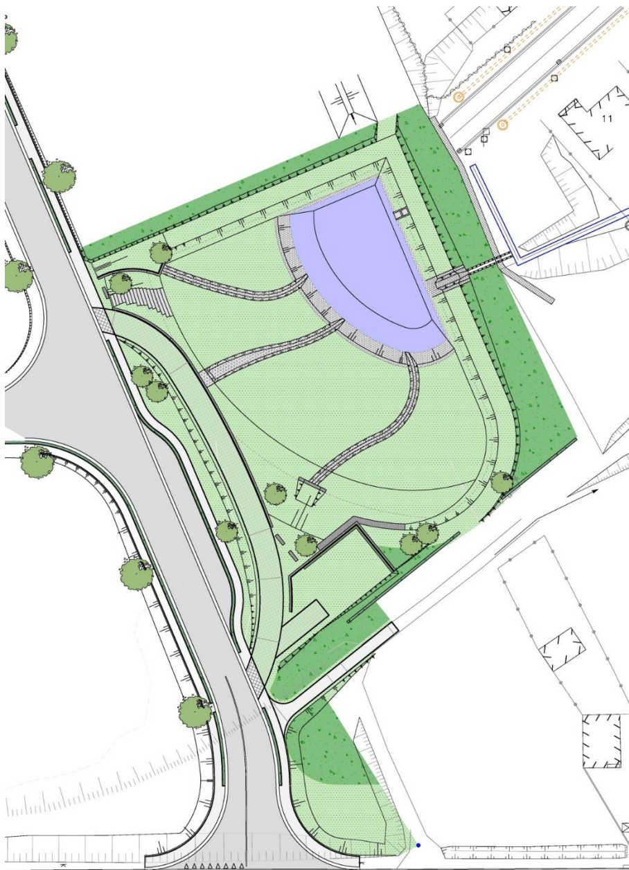
Figuur 25: Kiwi-project 'amfithewater' in Tervuren – gemeenschappelijke waterbuffering voor bedrijven op het bedrijventerrein [19]
